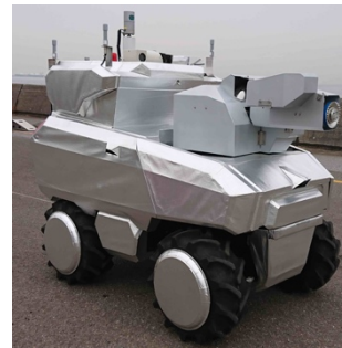
図 アルミ蒸着布、内部に水噴霧装置を備えた放水砲ロボット
