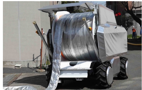
図 耐熱性の高いホースを積載したホース延長ロボット
