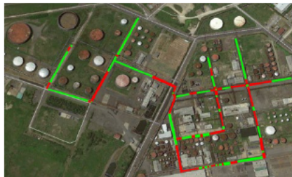
図 石油化学コンビナート内での GPS による位置測定結果 赤：精度不十分、緑：精度良好
